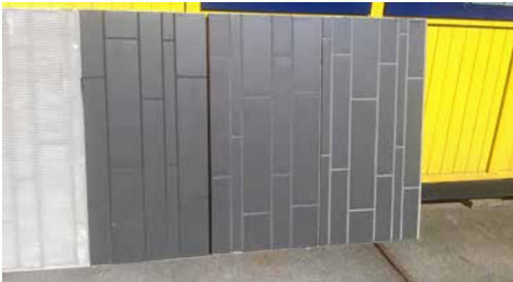
Keramische tegels worden verlijmd op isolatiesysteem
